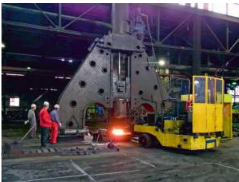
Figura 35 - Esempio di monitoraggio della posizione relativa degli operatori autorizzati rispetto ad una macchina fissa (forgia) che lavora elementi incandescenti [wikipedia].
