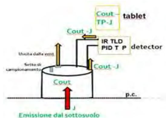
Figura 1: Schema della camera di accumulo
