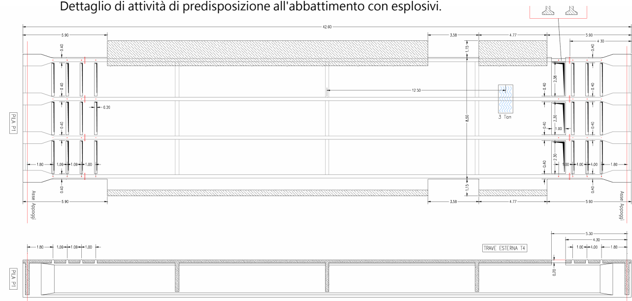
Dettaglio di attività di predisposizione all'abbattimento con esplosivi.
