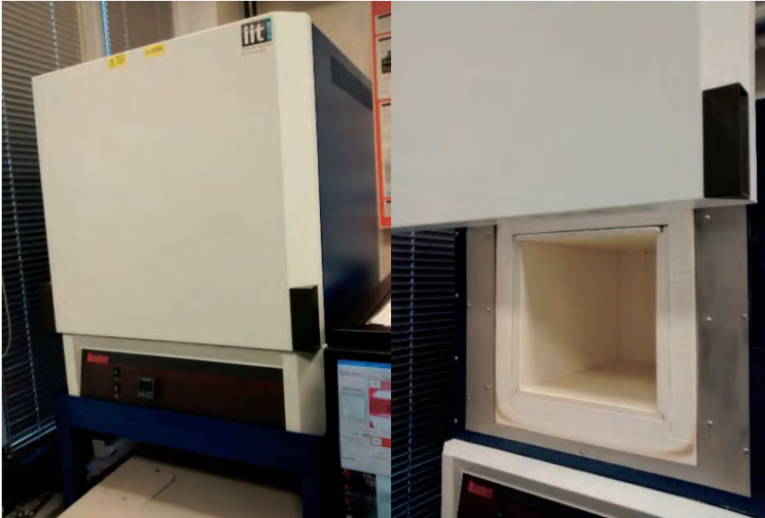
Forno per la pulizia di parti del reattore CVD per la crescita di grafene
