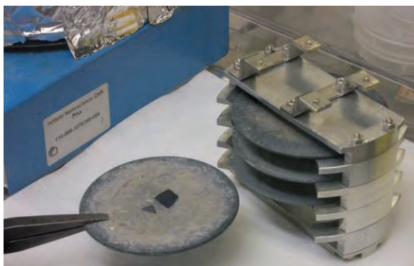
Serie di porta campioni in molibdeno dei substrati cristallini per la crescita di nanofili
