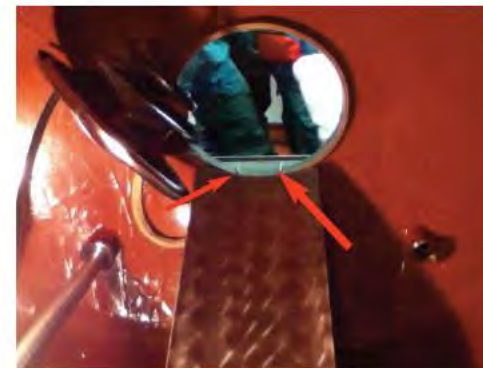
Nella foto in alto, tavola posizionata all'interno dell'autoclave, le frecce indicano i ganci di fermo della tavola aderenti al bordo del passo d'uomo senza ridurne il lume.
